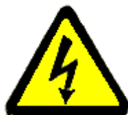
Tensione elettrica pericolosa
